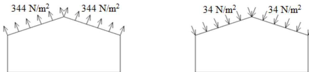
Figura 2. Distribuição de cargas devido ao vento
