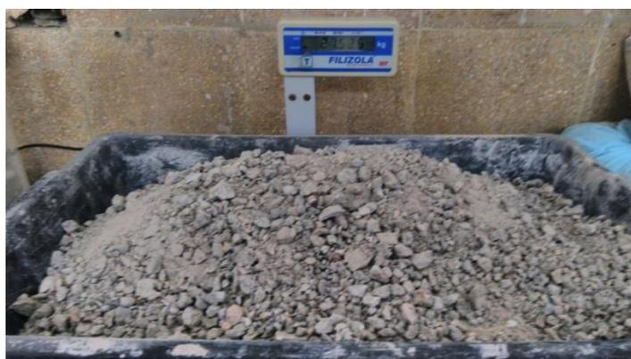
Figura 2. Agregado resultante do processo de britagem
