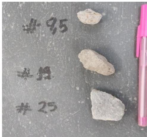
Figura 3. Graduação dos agregados a partir da retenção nas peneiras 9,5mm, 19mm, 25mm.
